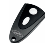
Micro-Novotron 512 2-Kanal, 433 MHz, KeeLoq-Wechselcode
