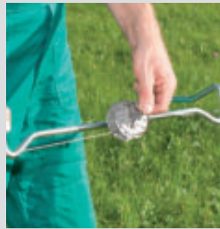
3. Spannbugel in den Draht einhangen, Sicherungsbugel einsetzen und Spannbugel entnehmen
