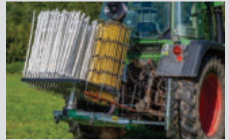
Wechselbares Magazin für bis zu 400 Pfähle
