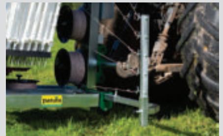
Beidseitiges Arbeiten durch umsteckbaren Auslegearm
