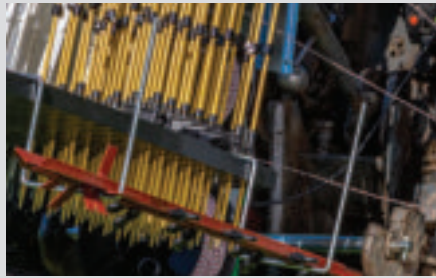
Universalhaken zur zusätzlichen Aufnahme von Eckpfählen oder zusätzlichen Haspeln
