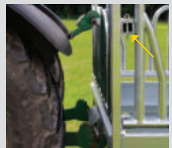
Einfacher Transport über Ackerschleife und abnehmbarer Oberlenkeranhangung aus 8 mm starkem Vierkantröhre
